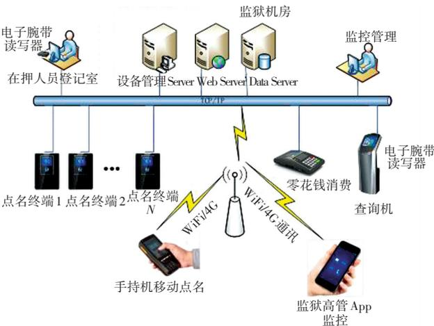
图 2 系统架构设计图 2
