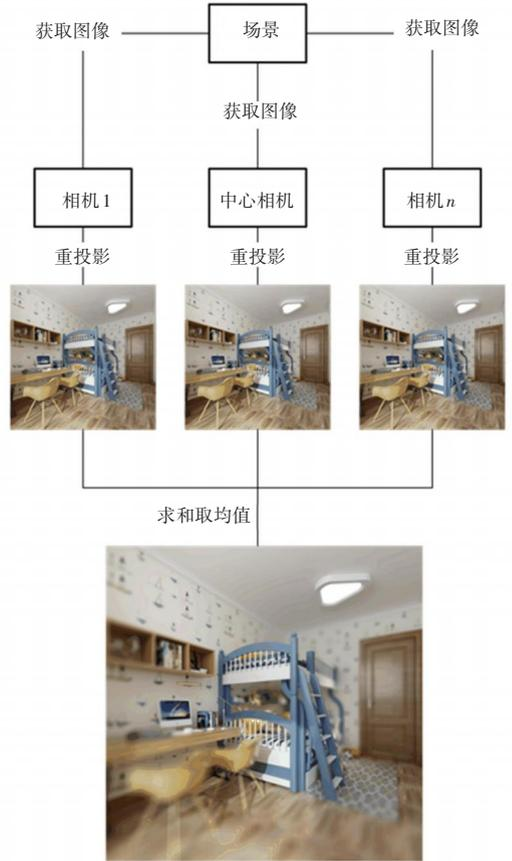
图 11 重聚焦算法流程示意图
