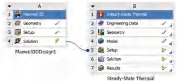
图 4 ANSYS 中建立热电耦合工程图
