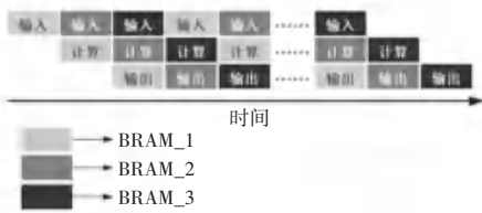
图 4 采用三重缓冲后的时序图
