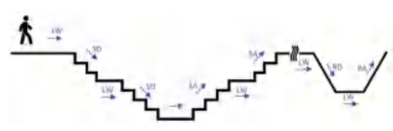
图 4 楼梯测试和斜坡测试 Fig. 4 Stair test and ramp test
