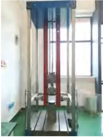
图3 DHR-1707型落锤冲击示意图
