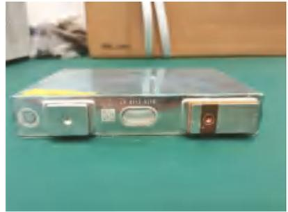
图2 三元聚合物锂离子电池示意图
