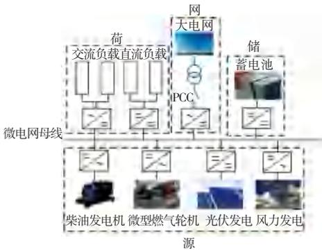
图 1 微电网架构
