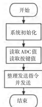
图5 遥控运行流程图
