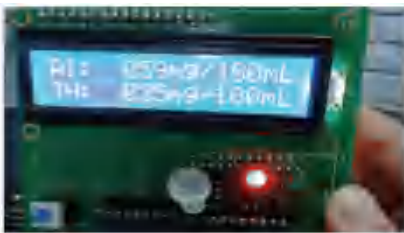
图 5 酒精浓度在线检测仪实验结果
