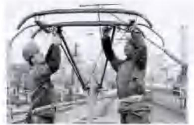
图5 人工检测受电弓
