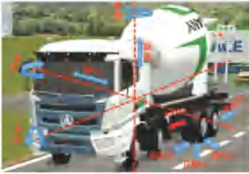
图 1 搅拌车作用力示意图
