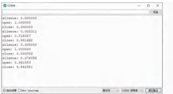
图 10 使用 TFLite 模型进行模型推理
