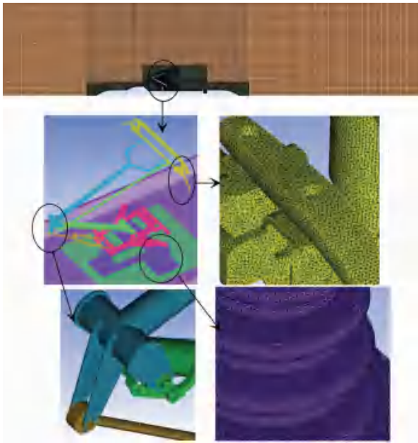
图6 网格划分细节 Fig. 6 Meshing details
