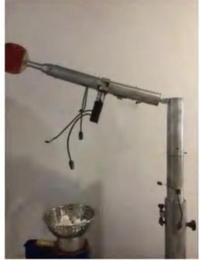
图1 五自由度乒乓球发球机械手
