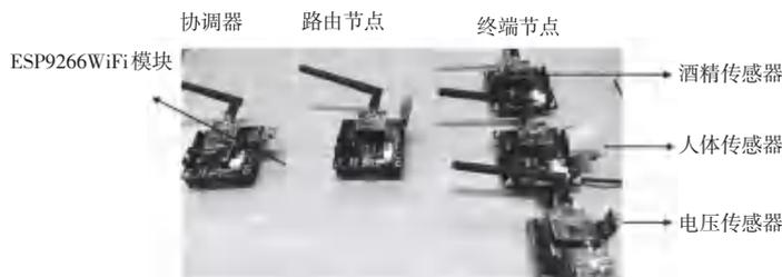
图4 ZigBee 实物连接图
