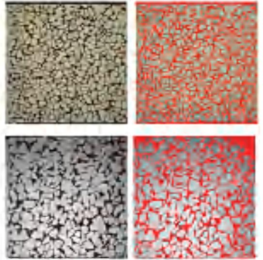
图 1 微观驱替实验图像和 Otsu 算法分割图
