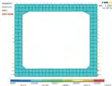
图3 侧向土压力、顶板上方压力及自重荷载示意图
