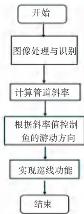
图3 巡线功能算法流程图
