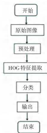
图4 检测功能算法流程图
