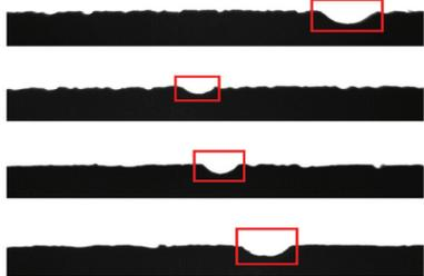
图 2 刀具边缘图像示例图
