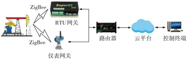
图 1 应用新型死点开关的油田监测系统
