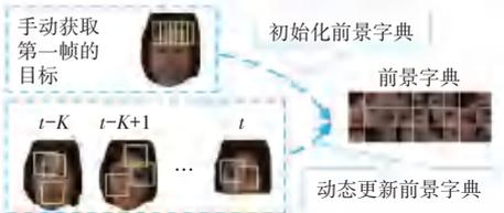
图2 动态手势图像的采集和视觉更新模型
