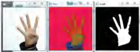
图 3 基于 HSV 颜色空间的肤色提取示例图
