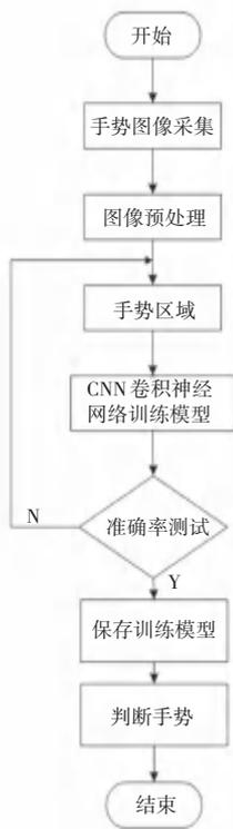
图1 总体设计流程
