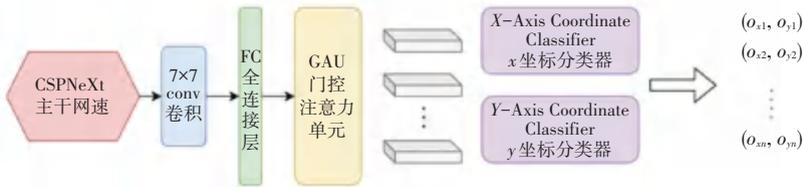
图 4 RTMPose 总体框架图
